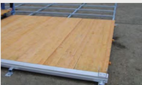
Module 10,00 m x 3,00 m complet : Ossature en acier galvanisé double nappe avec rail aluminium forme H + plancher en épicea tri plis 21 mm vitrifié 2 faces, en lames de 0,50 m x 3,00 m avec lambourde.
