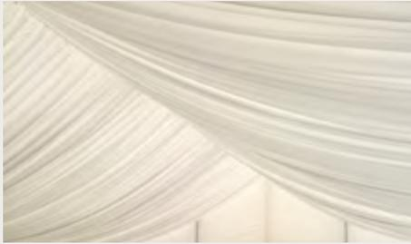
Confection en tissu 100 % polyester de 155 gr/m<sup>2</sup> classé au feu M1 coloris blanc (autre coloris sur demande), à accrochage par mousqueton sur câble. Plissage 1,5 pour les toitures et droit pour les pointes de pignon. Éléments solidarisés par velcro. 1 kit d'accrochage départ compris dans chaque vélum base structure.
