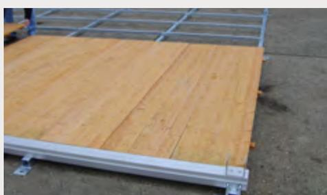
Module 8,00 m x 3,00 m complet : Ossature en acier galvanisé double nappe avec rail aluminium forme H + plancher en épicea tri plis 21 mm vitrifié 2 faces, en lames de 0,50 m x 3,00 m avec lambourde.
