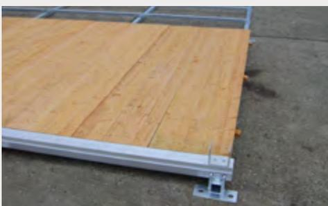
Module 5,00 m x 3,00 m complet : Ossature en acier galvanisé double nappe avec rail aluminium forme H + plancher en épicea tri plis 21 mm vitrifié 2 faces, en lames de 0,50 m x 3,00 m avec lambourde.
