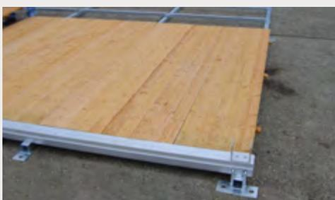
Module 3,00 m x 3,00 m complet Ossature en acier galvanisé double nappe avec rail aluminium forme H + plancher en épicea tri plis 21 mm vitrifié 2 faces, en lames de 0,50 m x 3,00 m avec lambourde.
