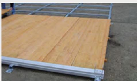
Module 6,00 m x 3,00 m complet : Ossature en acier galvanisé double nappe avec rail aluminium forme H + plancher en épicea tri plis 21 mm vitrifié 2 faces, en lames de 0,50 m x 3,00 m avec lambourde.
