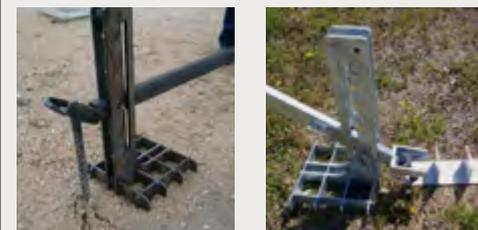
Matériel en acier galvanisé spécialement conçu pour retirer les pieux lors du démontage des tentes.
