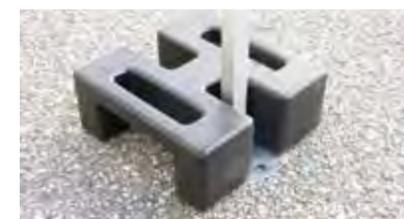
Ces matériels sont destinés exclusivement aux implantations de courte durée, en ayant préalablement consulté la météo locale. Ils doivent être démontés ou évacués à partir de 70 km/h de vent. Si le liaisonnement au sol est fait à l'aide de lestage, respectez les masses suivantes par poteau : 3 x 3 = 85 kg / 3 x 4,5 = 130 kg / 3 x 6 = 120kg / 4 x 4 = 150 kg et 5 x 5 = 235 kg.
