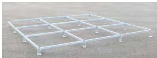
Plancher modulable à l'infini en longueur et en largeur, réglable en hauteur de 190 mm à 240 mm, jusqu'à 540 mm avec calage bois. Composé de seulement 3 types de pièces standards : pied, longeron et plaque de plancher. Il peut être mis en œuvre rapidement et très facilement par toute personne non professionnelle. Ce plancher est prévu pour un usage intérieur et extérieur couvert, pour une utilisation tout temps. Prévoir un passage en lasure des panneaux de plancher.
