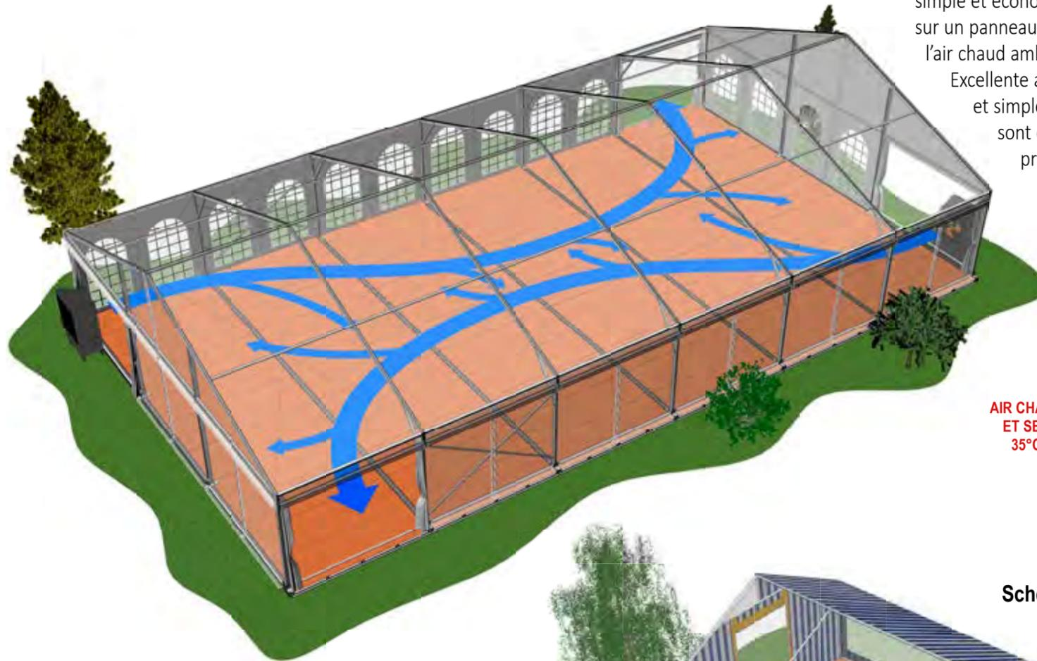
Notre gamme de rafraîchisseur d'air mobile utilise un principe, naturel, écologique, simple et économique : l'évaporation. Grâce à une pompe qui diffuse l'eau du réservoir sur un panneau alvéolaire cellulosique, ainsi maintenu humide, la ventilation aspire l'air chaud ambiant à travers ce panneau, refroidissant le flux d'air sortant.
